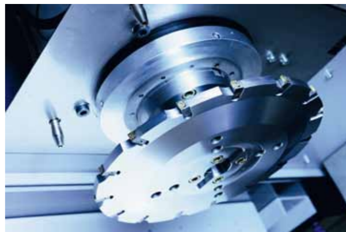
Dieser mobile Scheibenfräser wird zur Bearbeitung von Großbauteilen, etwa Turbinengehäusen, eingesetzt.
