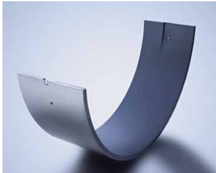
Hauptlager ermöglichen die radiale Positionierung der Kurbelwelle im Motor und die Kraftübertragung im Kurbeltrieb.
