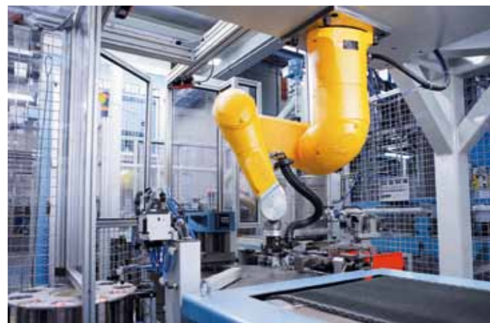
Dieser Überkopf-Roboter ist Teil einer Produktionslinie für Reibbeläge und ermöglicht den vollautomatischen Transport der Komponenten von einer Station im Produktionsablauf zur nächsten.
