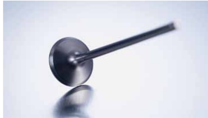
Dieses Auslassventil eines F1-Motors ist mit einer speziellen PVD-Beschichtung veredelt. Die Beschichtung leistet Hochtemperaturkorrosionsschutz, reduziert Gewicht und verbessert die tribologischen Eigenschaften des Bauteils.
