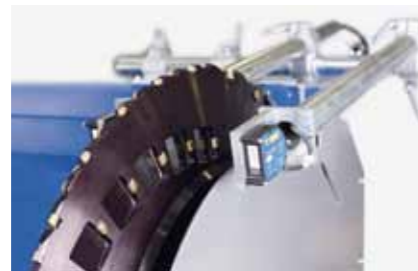
Dieser Profilfräser dient der Schweißnahtvorbereitung im Windturmbau.
