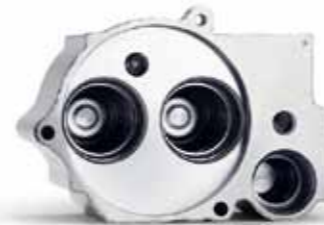
Das Pumpengehäuse ist 105 x 70 x 60 mm groß und wiegt 540 g. Die Chemisch-Nickel-Beschichtung selbst wird mit einer Dicke von 17 µm aufgetragen. Die Miba Coating Group beschichtet etwa 200.000 Pumpengehäuse pro Jahr für den europäischen Pkw-Markt.
