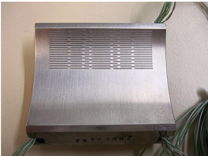
*Durch die gezielte Störung der laminaren Strömung mittels Nuten in der Lagerlauffläche, kann in definierten Bereichen ein laminar-turbulenter Strömungsumschlag angeregt werden.*
